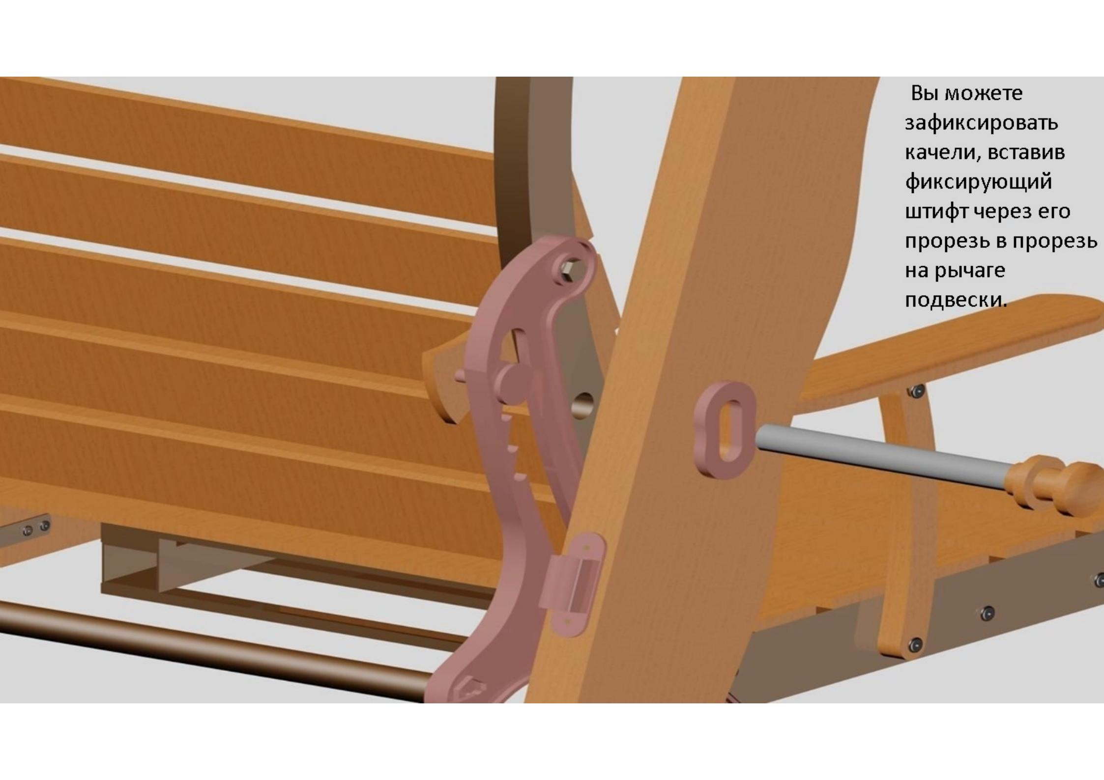
Вы можете зафиксировать качели, вставив фиксирующий штифт через его прорезь в прорезь на рычаге подвески.
